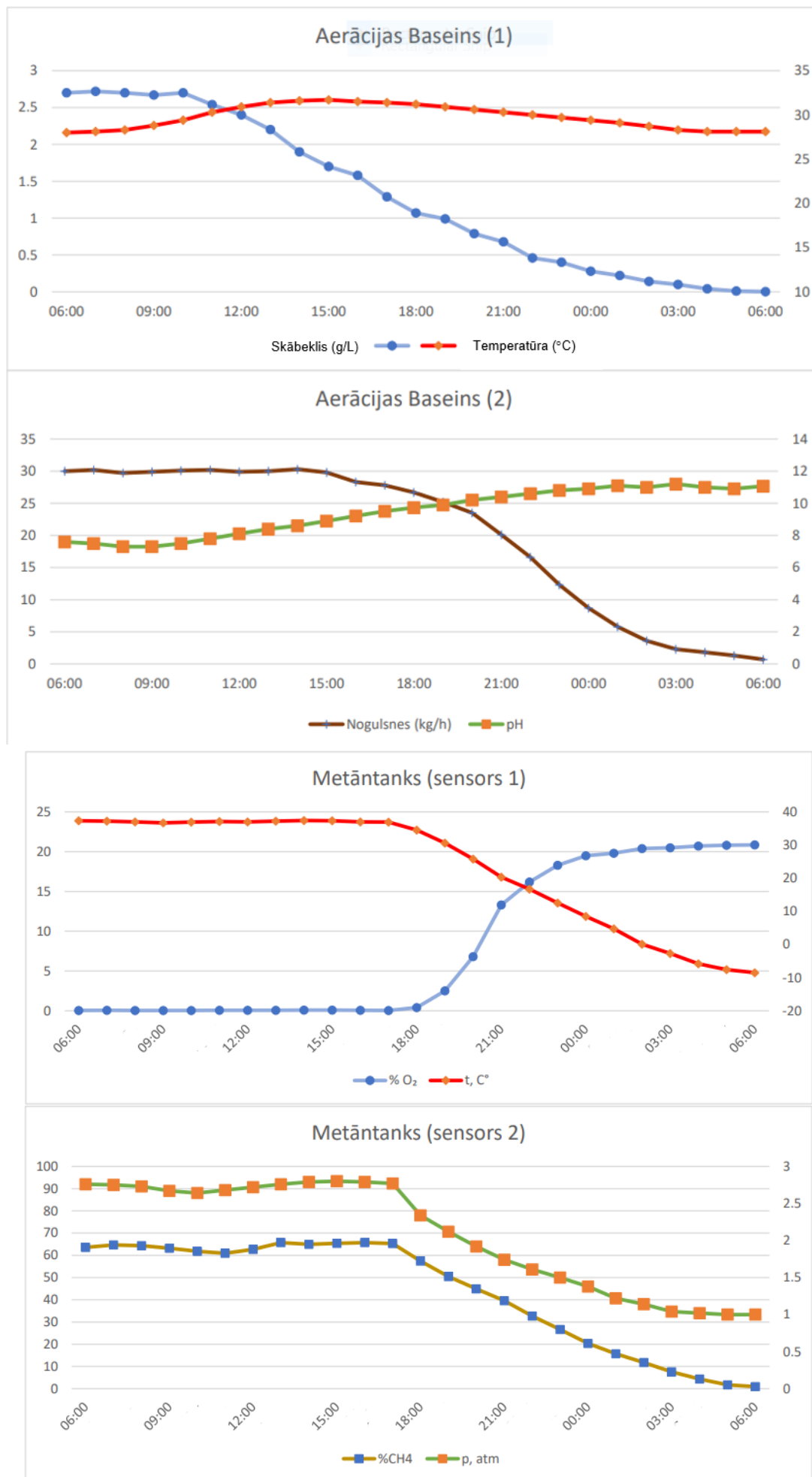
Att. IV.3: četri grafiki, kas uzstādīti ar sensoru palīdzību notekūdeņu attīrīšanas stacijā "Daugavgrīva".
